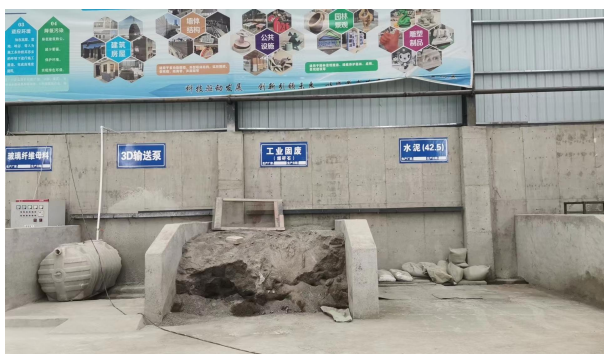
3D 打印生产线原料仓
